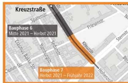
Die Gleise in der Kreuzstraße werden bis rund 60 Meter vor der Kreuzung Sternstraße erneuert, die Gehwege erhalten bis zur Sternstraße ein neues Pflaster.
